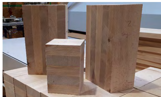
Abb. 7: Zur Holz Trocknung gestapeltes Projektholz (rechts) und gefertigte Brettsperrholz-Prüfkörper für Brandversuche an der HS Magdeburg-Stendal (links)
