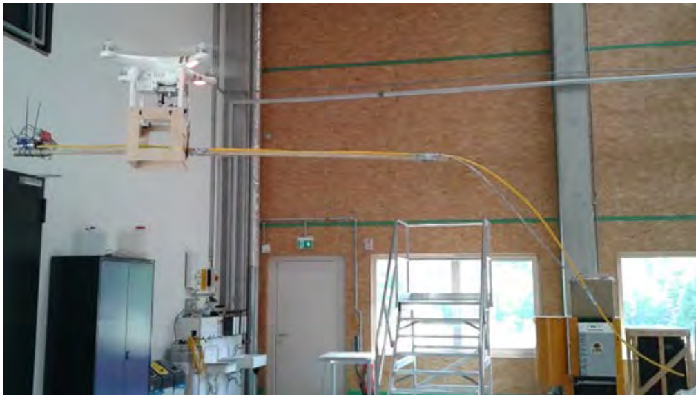
Abb. 18: Fliegender Prototyp einer kommerziell erhältlichen Drohne mit angebaute VOC-Sampling-System für die Beprobung des Kronenraumes
